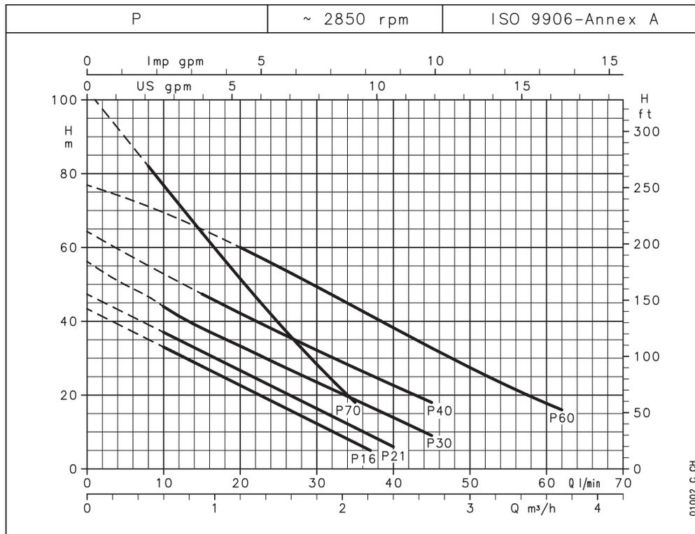
Tableau des performances hydrauliques ~2850 min<sup>-1</sup> 50 Hz
