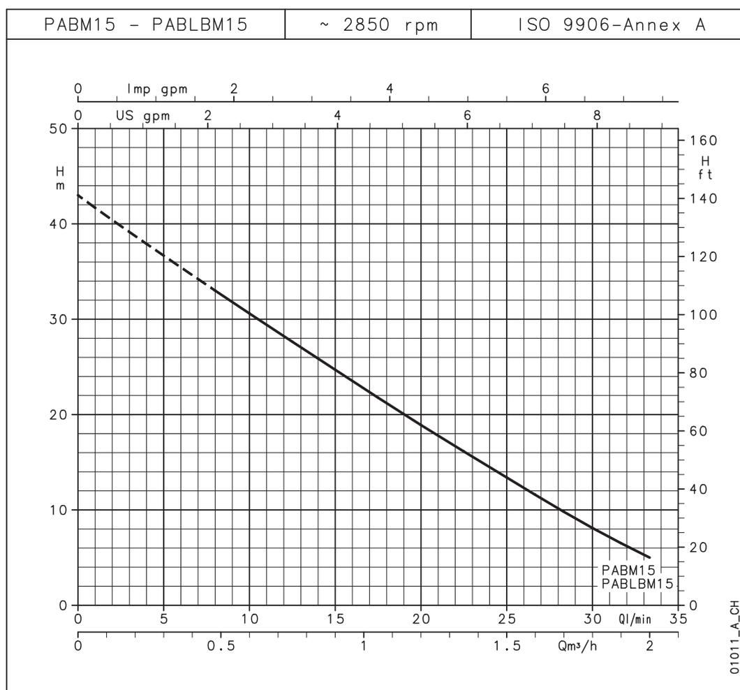
Tableau des performances hydrauliques ~2850 min<sup>-1</sup> 50 Hz
