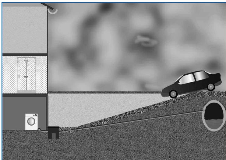
BEST BOX Garage est destiné à être enterré au point d'arrivée en descente du garage.
