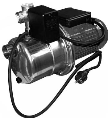
Électropompes centrifuges monophasées prévues pour la réalisation d'un groupe autoclave déjà assemblé avec manomètre, pressostat, raccord en laiton et câble d'alimentation.
