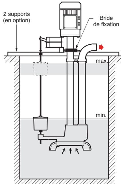
**NOTA:** l'amorçage de la pompe ne s'effectue que lorsque le corps de pompe est immergé. L'interrupteur électrique permet en fonction du réglage des butées haute et basse du flotteur, l'arrêt et la mise en route automatique de la pompe.
