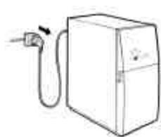
Débrancher le tuyau d'eau osmosée et ouvrir la vanne 1/4 de tour
