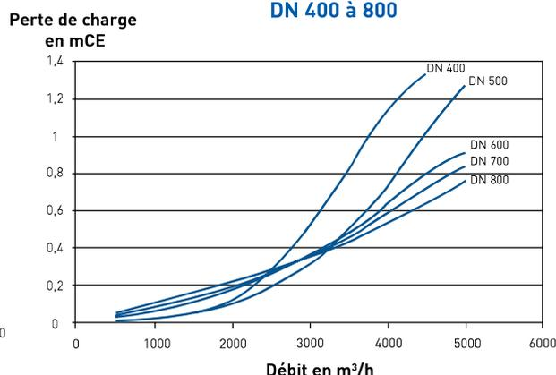
Courbes établies pour une eau à +20°C, clapet standard monté sur conduite horizontale.
