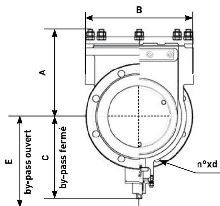
Si nécessaire, le robinet du by-pass peut être facilement remplacé sur site par une soupape de décharge.
