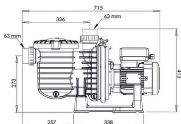
Pompe auto-amorçante jusqu'à 5 m au dessus du niveau de l'eau.
