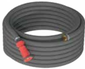
Lance pompier type douche éclateur laiton D19mm + couronne de 20 de tuyau pour kit KSDT. Diamètre 19 mm - PN25. Livré avec raccord laiton femelle 3/4".
