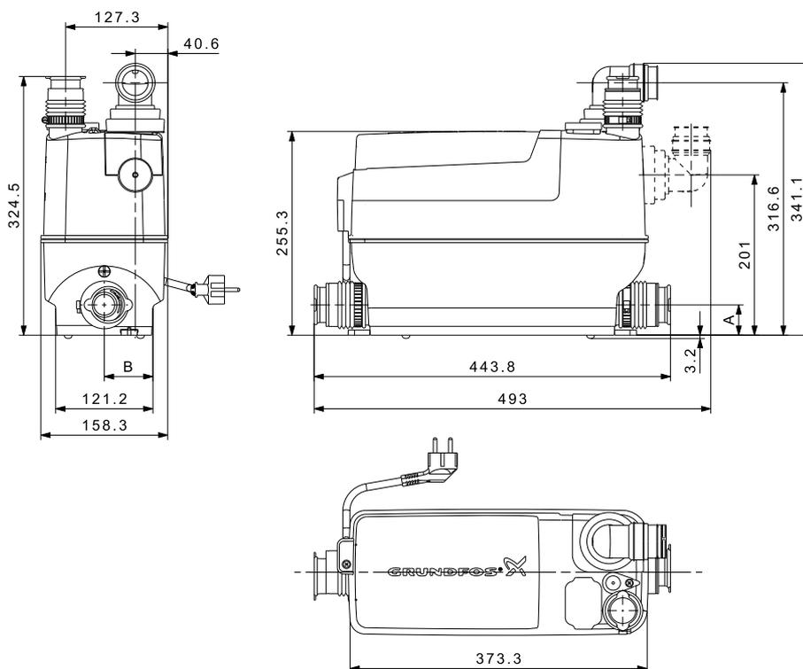
Fig. 37 Dimensions, Sololift2 C-3
