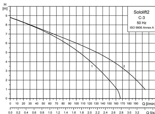
Fig. 36 Courbes caractéristiques du Sololift2 C-3
