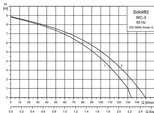
Fig. 18 Courbes caractéristiques du Sololift2 WC-3
