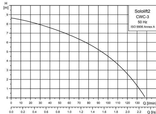
Fig. 26 Courbes caractéristiques du Sololift2 CWC-3
