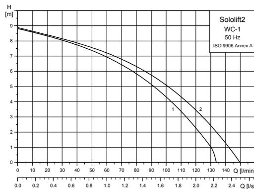
Fig. 9 Courbes caractéristiques du Sololift2 WC-1
