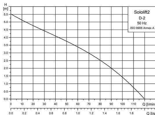
Fig. 43 Courbes caractéristiques du Sololift2 D-2
