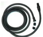
Kit composé d'un flexible 7 m, diamètre 28 mm, d'un clapet crépine 1"1/4, et d'un jeu de raccords union de 1"1/4 F ou M et 1" F pour raccordement pompe
