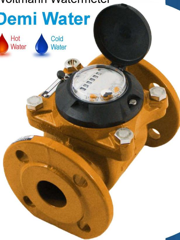
Cette gamme de Compteurs Woltmann est utilisée afin de mesurer la consommation ou la production d'eau déminéralisée. Applications industrielles, pour eau froide ou eau chaude. Les parties métalliques en contact avec le fluide sont recouvertes de téflon, pour éviter la minéralisation.
