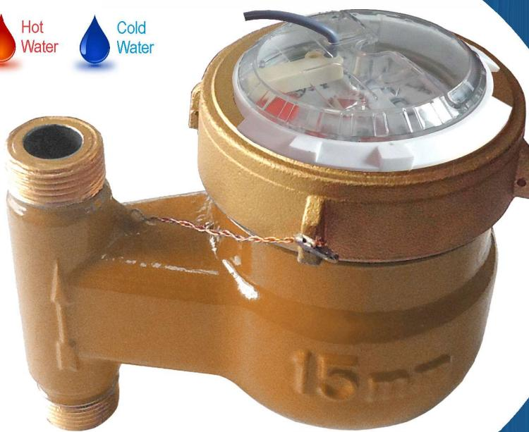
Cette gamme de Compteurs à Jet Multiple est utilisée afin de mesurer la consommation ou la production d'eau déminéralisée. Applications industrielles, pour eau froide ou eau chaude max 90°. Les parties métalliques en contact avec le fluide sont recouvertes de téflon, pour éviter la minéralisation. Utilisez toujours des raccords téflonnés.
