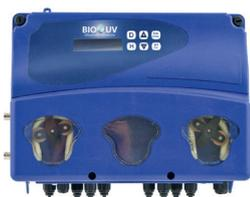
COMBIPOOL est un système automatique 2 en 1 qui associe injection de produit de désinfection et régulation du pH en fonction de 3 paramètres (volume du bassin, température et pH de l'eau). COMBIPOOL offre un manchon "4 en 1" et regroupe sondes et tubes d'injection.
