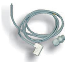
Tous les cadrans sont prédisposés pour le positionnement d'un émetteur d'impulsion, nécessaire pour intégrer l'appareil avec des systèmes de télé-relève ou de lecture à distance. L'horlogerie dispose de plusieurs rainures latérales pour fixer l'émetteur sans visserie, hors du cadran, et permettre la lecture du totalisateur et des décimales. L'émetteur d'impulsion est en Classe IP68 pour immersion totale.
