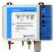
Le détecteur de fuite Eurovac LAZ-04/3 se présente sous la forme d'un boîtier en matière plastique qui comporte des voyants, des organes de commande et des indications. Il contient une pompe à vide, un interrupteur à pression, une platine électronique avec les composants qui génère l'alarme sonore et visuelle ainsi que le signal de sortie, un filtre et trois raccords pneumatiques pour la liaison vers l'espace inter-paroi du réservoir
