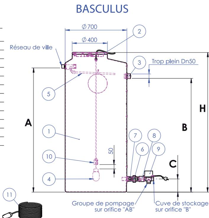
Les **BASCULUS 300 et 500** sont à installer avec un système de pompage type :
