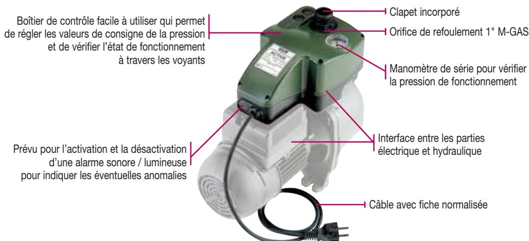
Le système "ACTIVE" intégré à une pompe JET, JETINOX, JETCOM ou EURO-INOX l'automatise et contrôle son fonctionnement. Il maintient la pompe en fonction durant le puisage, arrête la pompe lorsque le puisage est interrompu et protège la pompe contre le manque d'eau.
