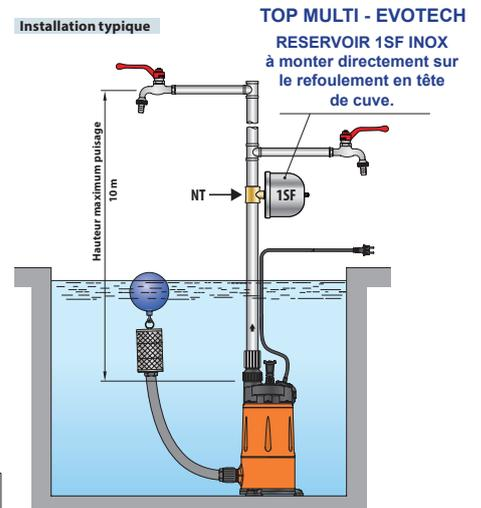
Ce réservoir 1SF est obligatoire sur une installation de TOP MULTI-EVOTECH, il permet de limiter le nb de démarrages.
