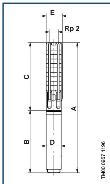
Les SP 8A-58 (N) à SP 8A-110 (N) sont montées dans des chemises avec raccordement R2.
