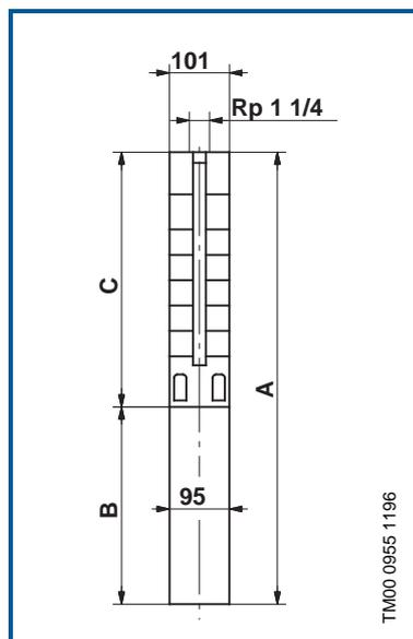
101 mm = Diamètre maxi de la pompe incluant le protégé-câble du moteur.
