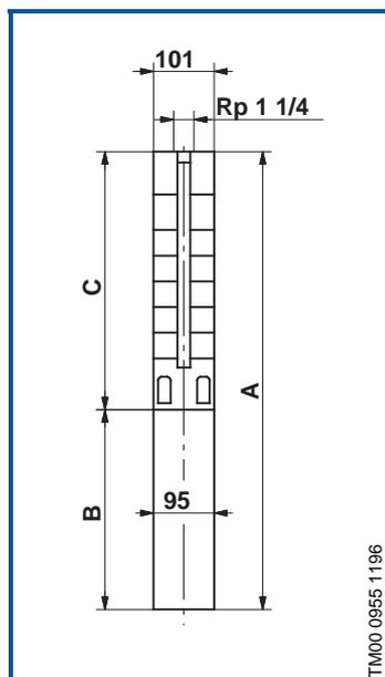
101 mm = Diamètre maxi de la pompe incluant le protège-câble du moteur.
