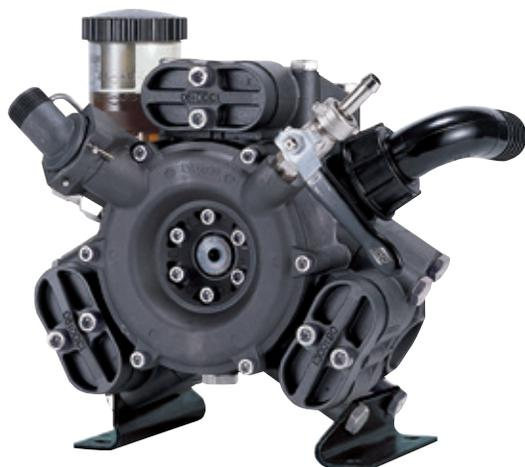
Pompe à **trois** membranes semi-hydrauliques pour le secteur de l'agriculture semi-professionnelle. Recommandée particulièrement pour la pulvérisation dans les jardins, serres et vignobles. Le corps de pompe est en aluminium et toutes les parties en contact avec des liquides de pulvérisation sont anodisées.
