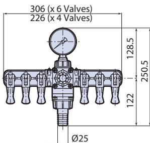
Groupe de commande avec vanne de régulation de pression de travail et équipé d'un manomètre avec cadran coloré.
