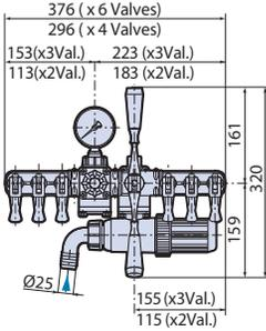
Groupe de commande avec vanne de régulation de pression de travail, levier d'ouverture/fermeture, anti-goutte, vannes pour réguler la dépression et manomètre avec cadran coloré.
