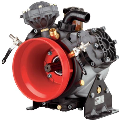
Pompe à **trois** membranes semi-hydrauliques avec chambre à air pour le secteur de l'agriculture professionnelle. Recommandée particulièrement pour la pulvérisation des vergers et des vignobles. Le corps de pompe est en aluminium et toutes les parties en contact avec des liquides de pulvérisation sont anodisées. La pompe est dotée d'un diaphragme remodelé pour empêcher son déchirement même dans les conditions les plus extrêmes d'utilisations.
