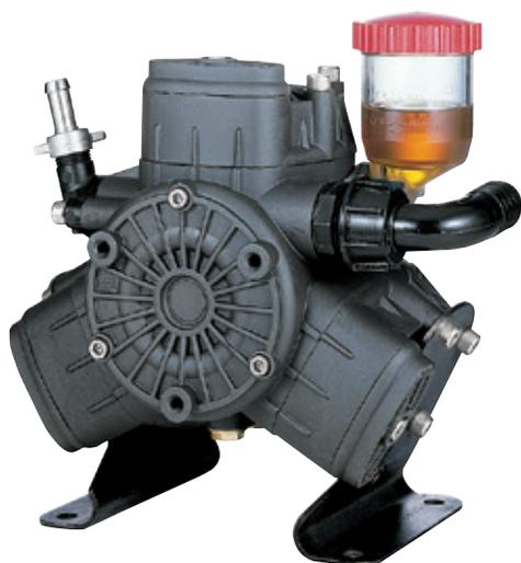
Pompe à **trois** membranes semi-hydrauliques pour le secteur de l'agriculture semi-professionnelle. Recommandée particulièrement pour la pulvérisation dans les jardins, serres et vignobles. Toutes les parties en contact avec des liquides de pulvérisation sont en aluminium anodisé.
