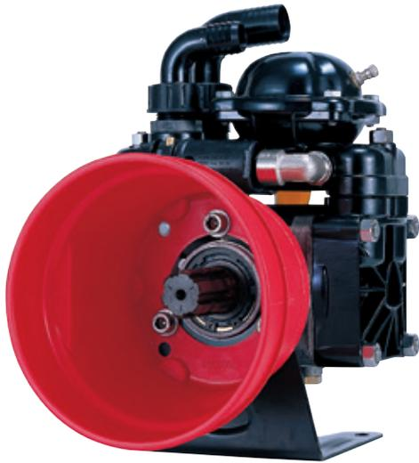
Pompe à **deux** membranes semi-hydrauliques avec chambre à air et soupape de sécurité. Toutes les parties en contact avec des liquides de pulvérisation sont en aluminium revêtu de matière plastique et d'acier inoxydable.
