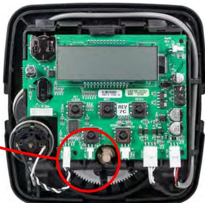
Lors du départ en régénération, la vanne active en premier le module C-NHBP125 pour fermer la sortie de l'adoucisseur, avant de lancer le premier cycle. Pendant la fermeture du module, l'affichage indique : L'indicateur de position passe de "ouvert", à "fermé"
